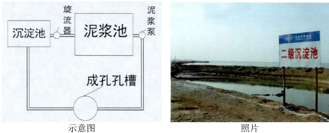
图 8.5-3 同类项目沉淀池示意图及现状照片
